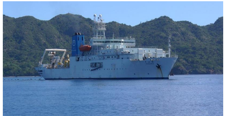
海底光ケーブル敷設船（すばる）全長130m
